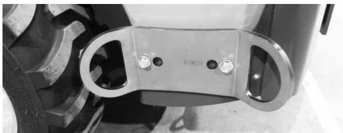
Festbrakett A418623 montert på siden av bakrammen. For sidemontering trenger du to braketter.
